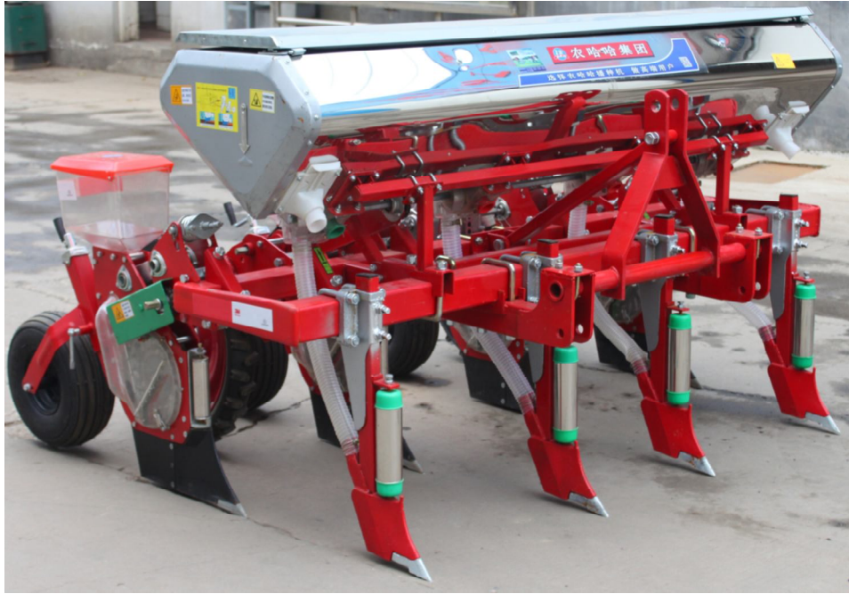
2BYFSF-4D 型玉米免耕施肥精播机
