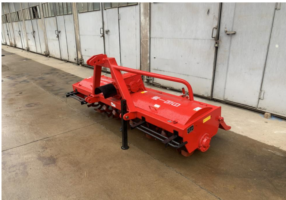
1GQN-230Z 型刚性机架旋耕机
